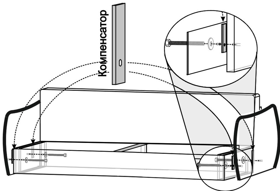
*Компенсатор устанавливается в места соединений в случае затруднительной работы выдвижного механизма (связанной с различной структурой и толщиной обивочных материалов используемых в изделии).*
